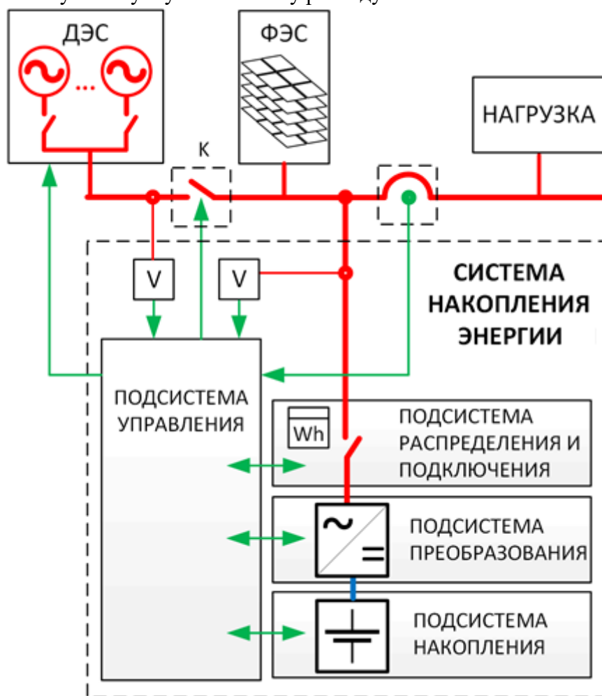
Рисунок 17 – Схема подключения СНЭЭ в составе гибридной электроустановки
